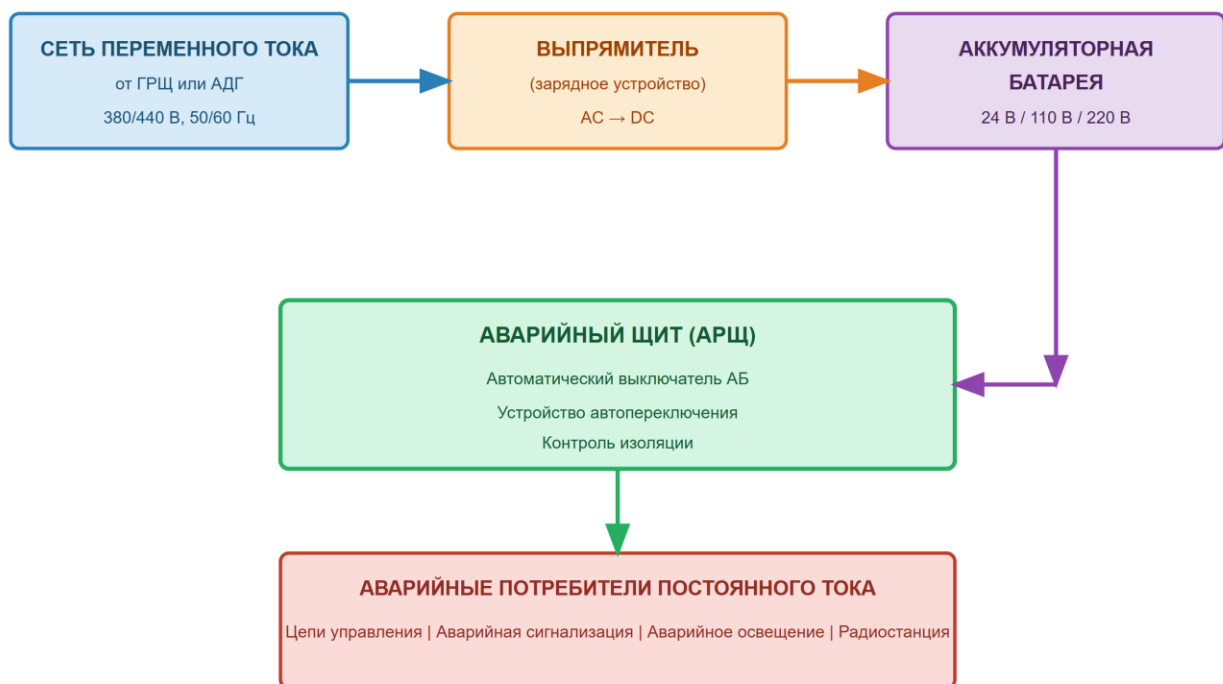
Рисунок 2. Схема подключения аккумуляторной батареи к аварийной сети
