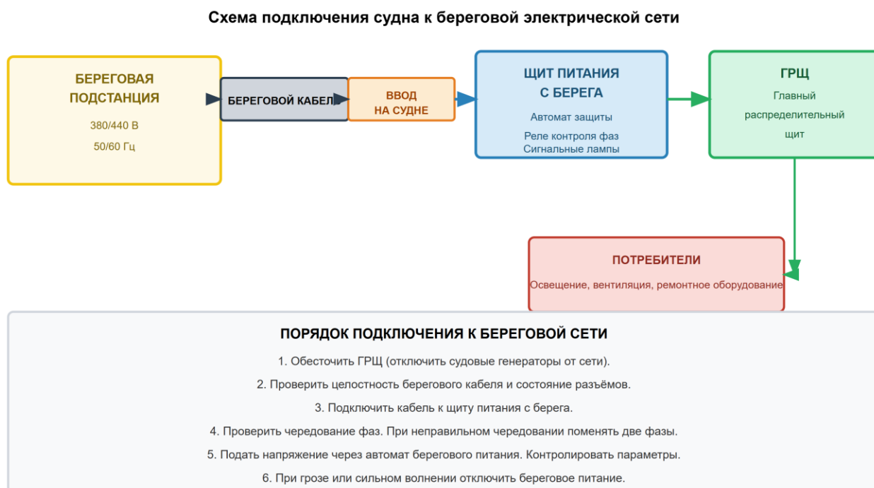
Рисунок 3. Схема подключения судна к береговой электрической сети
